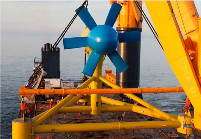
Figura 1. Ejemplo de turbina mareomotriz, Sabella, preparada para su instalación.
