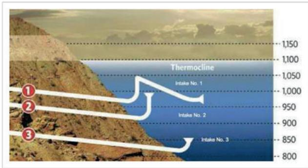
La captación está diseñada para mantener la capacidad de SNWA de sacar agua de la cuenca del río Colorado, a un nivel tan bajo como los 300 m sobre el nivel del mar. Esto garantizará la capacidad del sistema si los niveles del lago caen por debajo de la capacidad de elevación de la existente estación de bombeo PS-1. La estación de bombeo PS-3 evitará los continuos cortes en el suministro del agua a las municipalidades y usuarios finales cuando los niveles del lago caigan.
