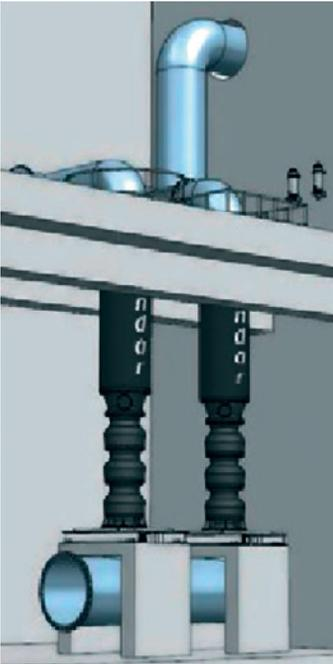
Figura 1. Bombas sumergibles multietapa de cámara seca.
