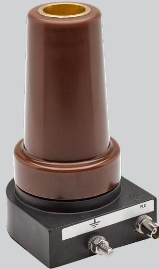
INGEPAC™ SR PG es un dispositivo que permite el acople de señales de comunicación PLC para celdas de aislamiento en gas. Existe una versión para celdas de hasta 36 kV y otra que incorpora un sensor de medida de tensión para celdas de hasta 24 kV.
