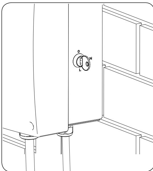
Sin embargo, si se activa la carga diferida mediante USB, ésta pasa a ser operativa. En este caso la *carga limitada* se desactivará, siendo sustituida por la carga diferida. Por este motivo, para seleccionar la carga diferida en la estación, se deberá seleccionar la posición *L* mediante la llave. La posición *N* seguirá siendo seleccionable para la *carga nominal*.
