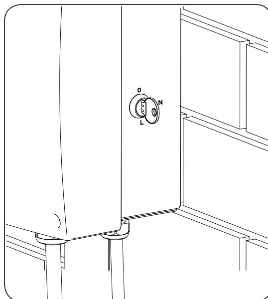
Néanmoins, si la charge différée est activée par USB, elle devient opérationnelle. Dans ce cas, la *charge limitée* est désactivée et remplacée par la charge différée. Pour cette raison, pour sélectionner la charge différée sur la borne de recharge, sélectionner la position *L* à l'aide de la clé. La position *N* pourra toujours être sélectionnée pour la *charge nominale*.
