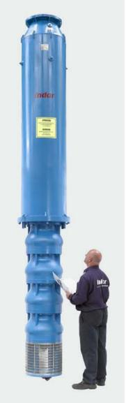
La serie **UGP** de la familia INDAR SP está compuesta de bombas y motores sumergibles diseñados para el bombeo de agua limpia, o con escasa cantidad de sólidos, en una amplia gama de aplicaciones. Los grupos **UGP** de agua limpia están constituidos por bombas centrífugas verticales y sumergibles multi-etapa, cuyo motor eléctrico está directamente acoplado a la parte de bomba y es igualmente sumergible. Tanto la bomba como el motor son diseñados y fabricados íntegramente por INDAR.
