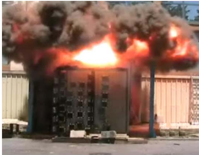
Ensayo de Arco Interno 50kA 0,5s.
