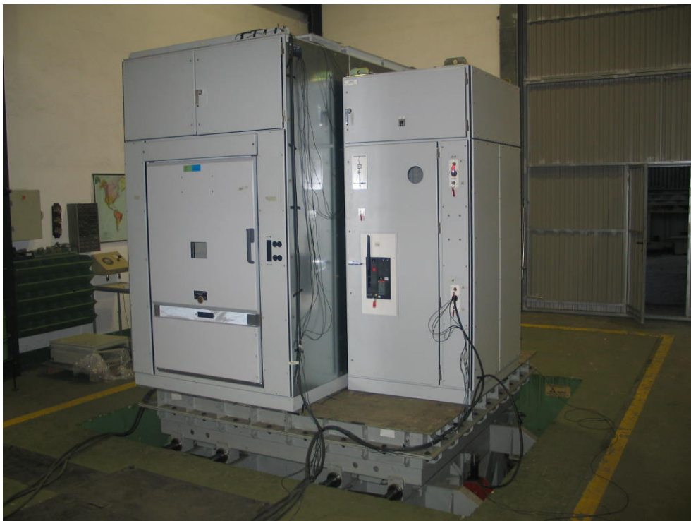
Ensayo de cualificación sísmica.
