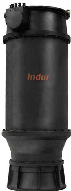
La **serie SP HE** está compuesta por bombas y motores sumergibles diseñados para el bombeo de aguas limpias o con sólidos en una amplia gama de aplicaciones. Las **bombas HE** son del tipo mono-celular, con impulsor de tipo axial o hélice con palas de inclinación variable y motor sumergible, especialmente diseñados para trabajos duros con aguas pluviales o residuales urbanas e industriales y aguas brutas. Tanto la bomba como el motor son diseñados y fabricados íntegramente por INDAR.
