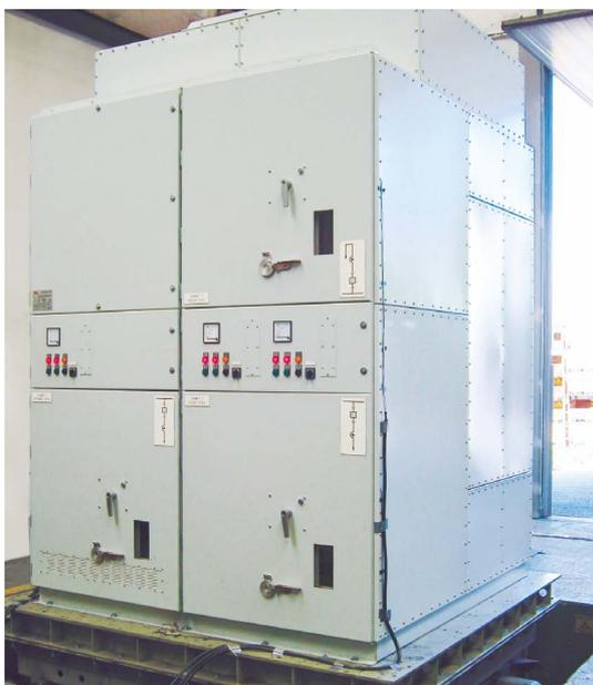
Cuadro durante la prueba de ensayo sísmico
