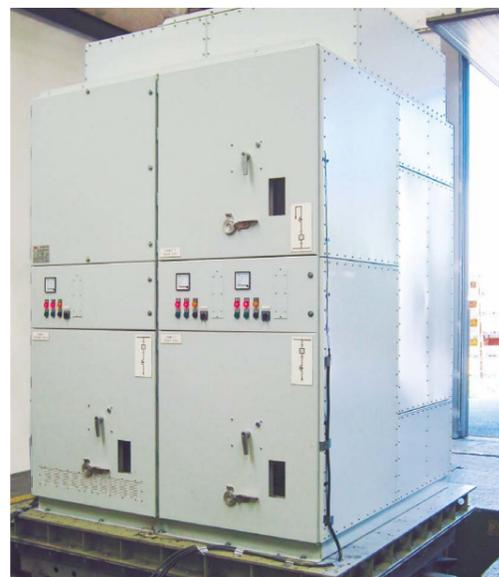
Cuadro durante la prueba de ensayo sísmico
