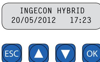
Este interface permite la visualización de los principales parámetros internos, y el ajuste del sistema completo durante la instalación.
