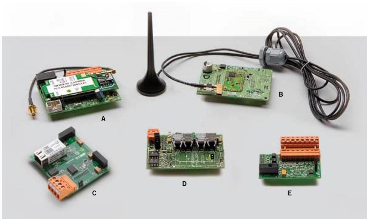
**A.** Tarjeta módem para la comunicación inalámbrica GSM/GPRS. **B.** Tarjeta para la comunicación inalámbrica en la banda ISM 868. **C.** Tarjeta Ethernet y RS-485. **D.** Tarjeta de fibra óptica. **E.** Tarjeta RS-485 para la comunicación entre los inversores que forman la instalación.
