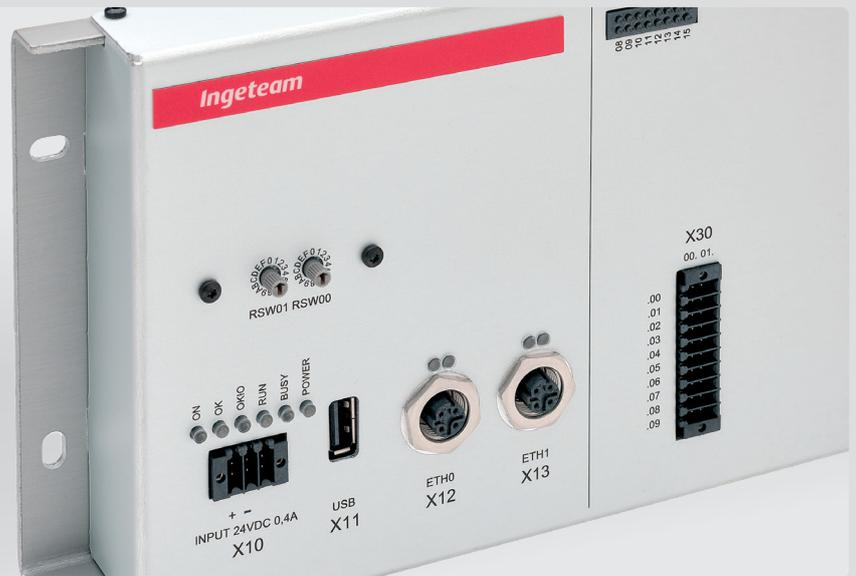
INGESYS™ RCM es una solución de monitorización del estado de activos que permite la captura y registro de los datos de operación de los distintos elementos de un tren y su posterior análisis en un puesto central remoto basado en arquitectura cloud mediante avanzadas herramientas de monitorización y análisis.
